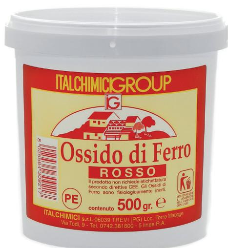
Gli ossidi di ferro sono pigmenti insolubili in acqua, resistenti agli alcali e hanno ottima stabilità alla luce e alle intemperie. Fino ad un limite del 10% (calcolato sul peso del cemento) il pigmento non influenza sensibilmente la resistenza del calcestruzzo. Adatto a colorare cemento e stucchi.
