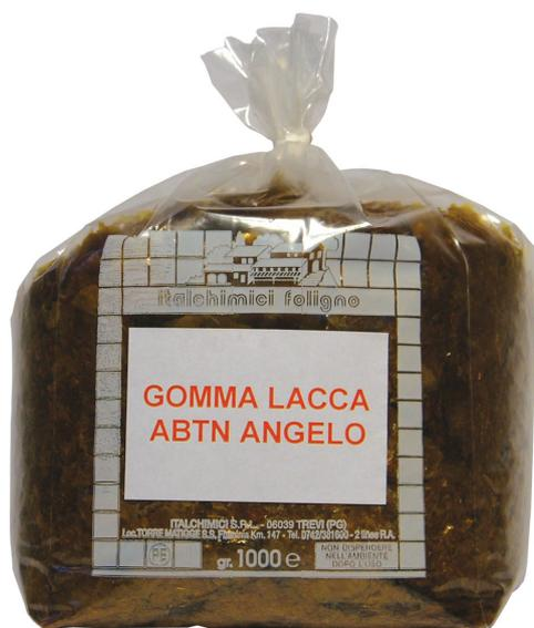
Si presenta in scaglie sottili e fragili, di colore giallo scuro. Prodotto naturale. Dopo essere stata sciolta in alcool preferibilmente 99,9° o nel solvente Etipa, si utilizza con uno straccio o un tampone a cerchi concentrici per la finitura di mobili di pregio.
