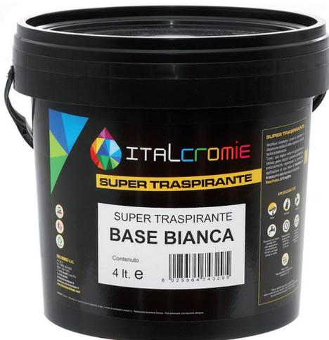
Idropittura traspirante a base di copolimeri in dispersione dotata di ottima copertura e grande facilità di distensione. Trova i suoi migliori campi di applicazione su intonaci, gessi, stucchi e pannelli prefabbricati, preferibilmente rispettando la preventiva applicazione di una mano fissativo all'acqua prima delle due mani di idropittura. Resa pratica : 8-10 mq/lt
